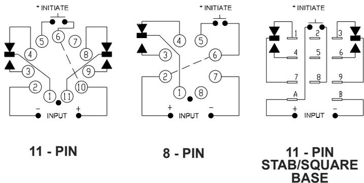
\* INITIATE NOT USED FOR INTERVAL, DELAY ON MAKE & RECYCLE MODES OF OPERATION
