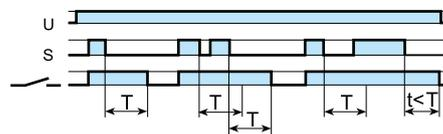
**(BE) Off-delay with control signal.**
